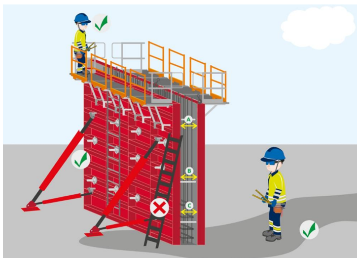
Rysunek 6 Zapewnienie dojścia do pomostu
