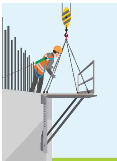
Rysunek 7 Zapewnienie konsoli wiszących
