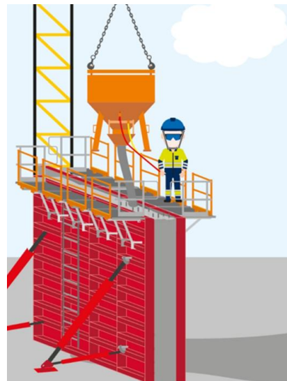
Rysunek 5 Zapewnienie pomostów roboczych
